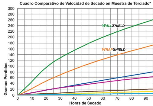
Las cualidades superiores de secado de WrapShield, una de las mas alta resistencia al agua, y la mejor permeabilidad al vapor de las membranas y barreras de aire comercializadas en la industria.
